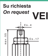
Vite esterna esagono incassato Leakproof hex socket screw
