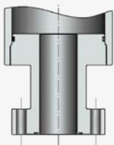
Beispiel 3: axialer Flanschanschluss example 3: axial flange connection
