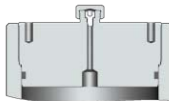
Beispiel 1: Füllventil für Membranspeicher M 28 x 1,5 example 1: filling valve for dia- phragm accumulator M 28 x 1,5
