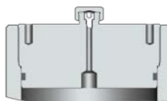
Beispiel 3: Füllventil für Membranspeicher M 28 x 1,5 example 3: Filling valve for dia- phragm accumulator M 28 x 1.5
